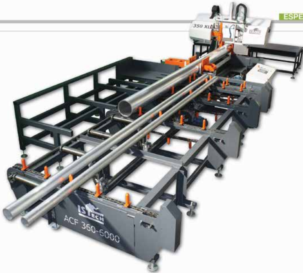
Impianto con caricatore a stazioni e Power 350XL base 15 di ISTeCH.
