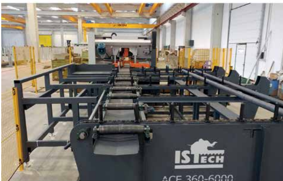
Le segatrici Power 670XL di ISTech hanno una corsa di carico particolarmente lunga, che permette avanzamenti della barra o del tubo in una sola ripresa fino a 3000 mm.
