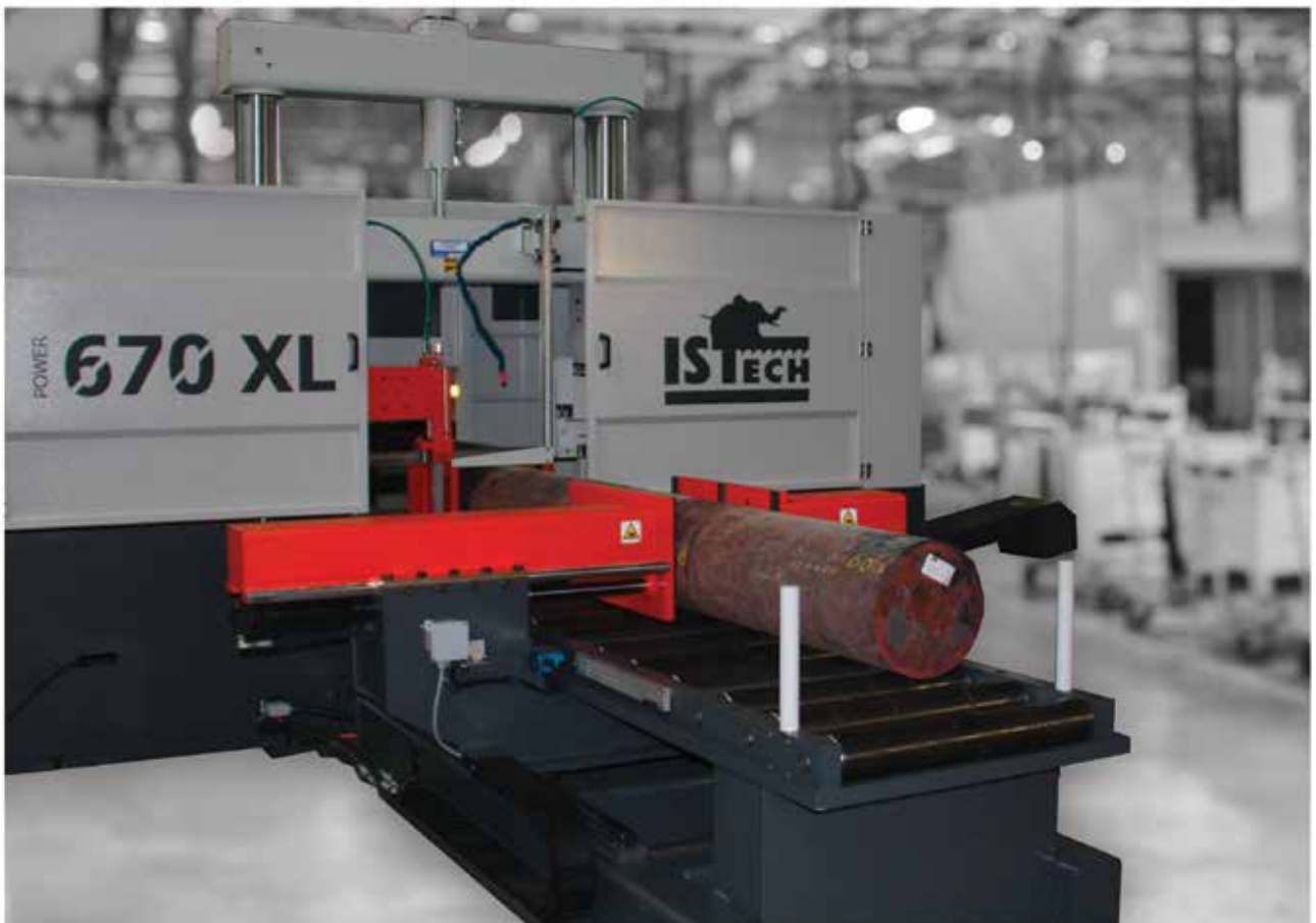
Le segatrici Power 670XL di ISTech hanno una corsa di carico particolarmente lunga, che permette avanzamenti della barra o del tubo in una sola ripresa fino a 3000 mm.
