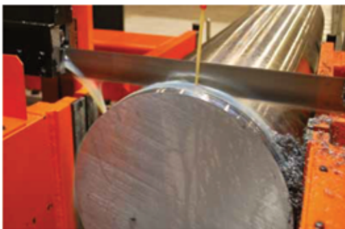
Taglio di barra in acciaio
